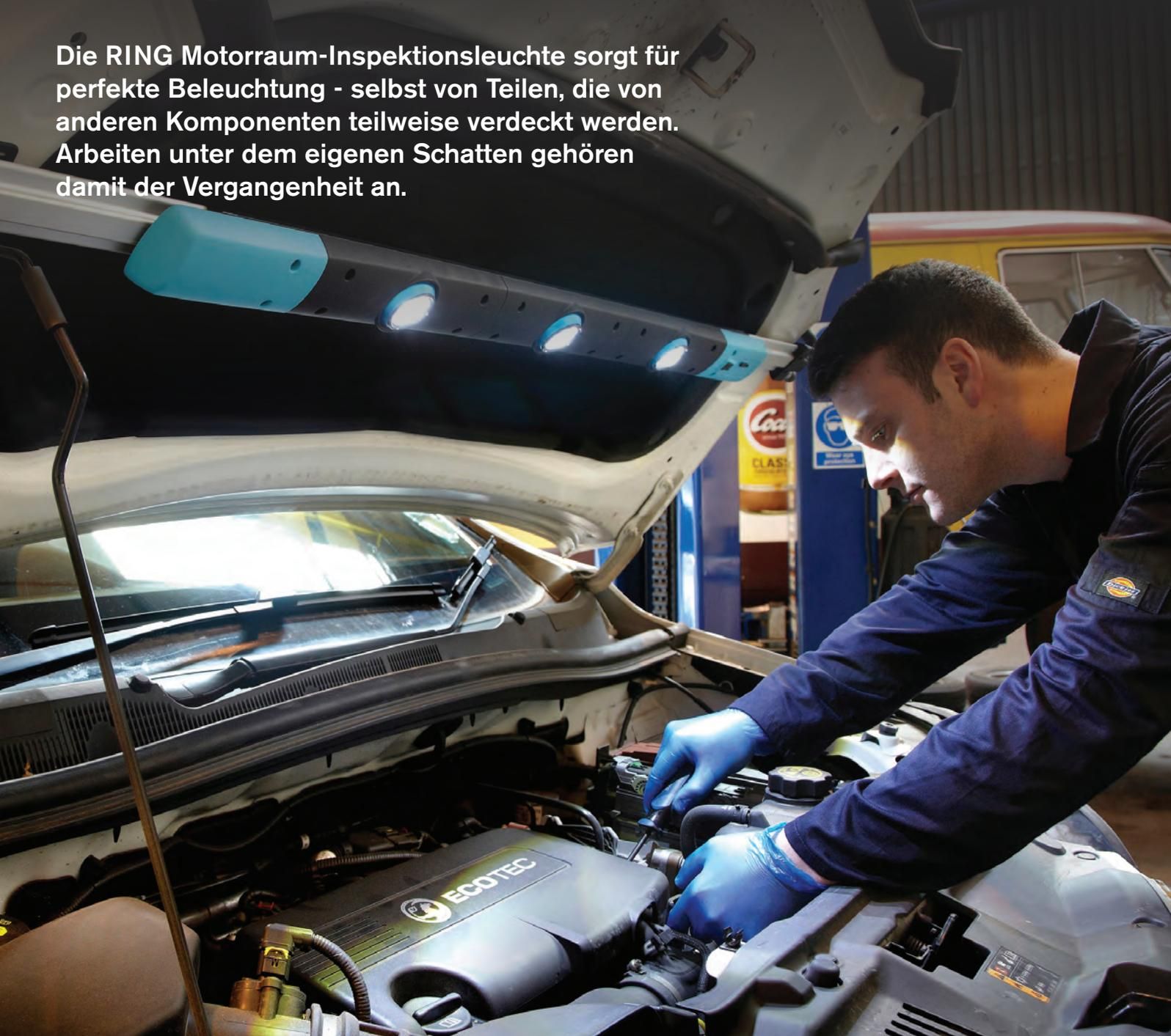
Mit einem kombinierten Lichtstrom von 1000 lm ist ein heller Arbeitsbereich garantiert. Aus Polykarbonat, ABS und Aluminium gebaut, verbindet die Leuchte geringes Gewicht mit der Robustheit, wie sie für den harten Einsatz in Werkstatt gefordert wird.
