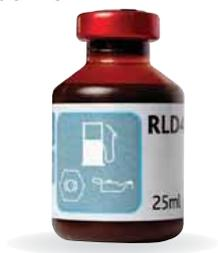
Zum Aufspüren von Hydrauliköl-, Motoröl- und Kraftstofflecks. Für alle Öltypen wie Mineralöle, halbsynthetische und synthetische Öle. Dosierung: 35 ml auf 8 bis 10 Liter Benzinmotoröl bzw. 3 bis 5 Liter Dieselmotoröl, auf 10 Liter Hydrauliköl und auf 15 Liter Benzin/Diesel.
