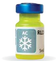
Findet jedes Kältemittelleck in Klimaanlage. Das Suchmittel mit der RDL5 Lecksuchmittelspritze in die Klimaanlage einspritzen, wonach es das System durchströmt. Danach können Leckagen durch Beleuchten mit UV-Licht zuverlässig erkannt werden. 5 ml pro 250 ml Kältemittel.
